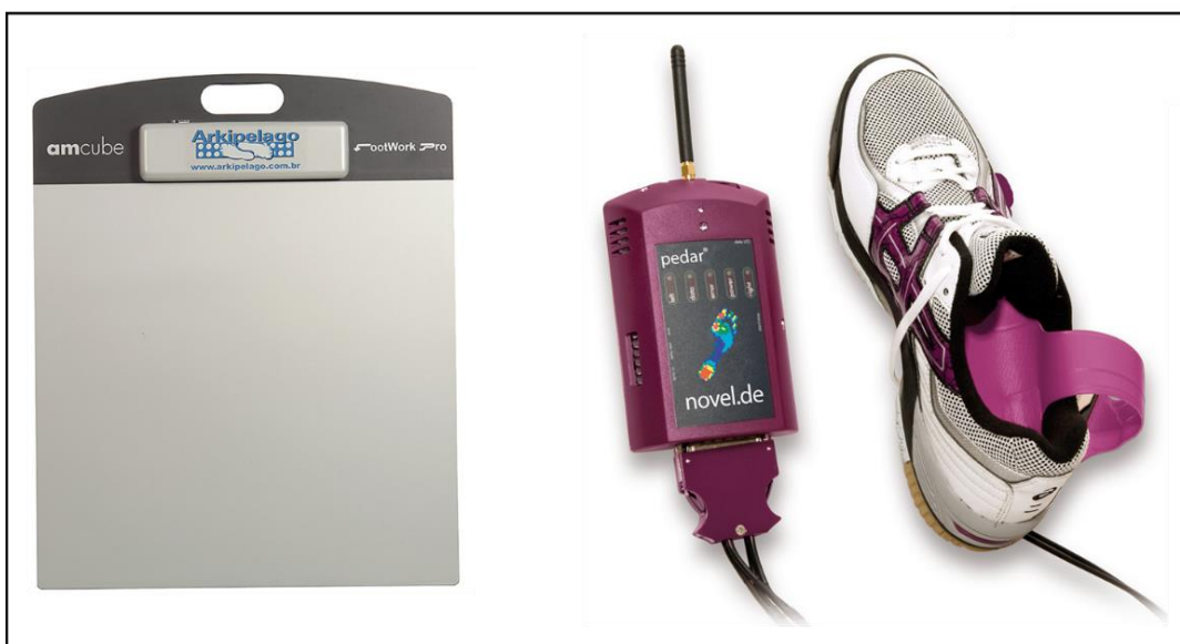
Figura 17. Plataforma Footwork Pro® (AM-Cube, Francia); Plantillas instrumentadas Pedar® (Novel, Alemania).
