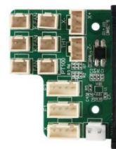
Figura 47: PCB de conexiones de impresora 3D
