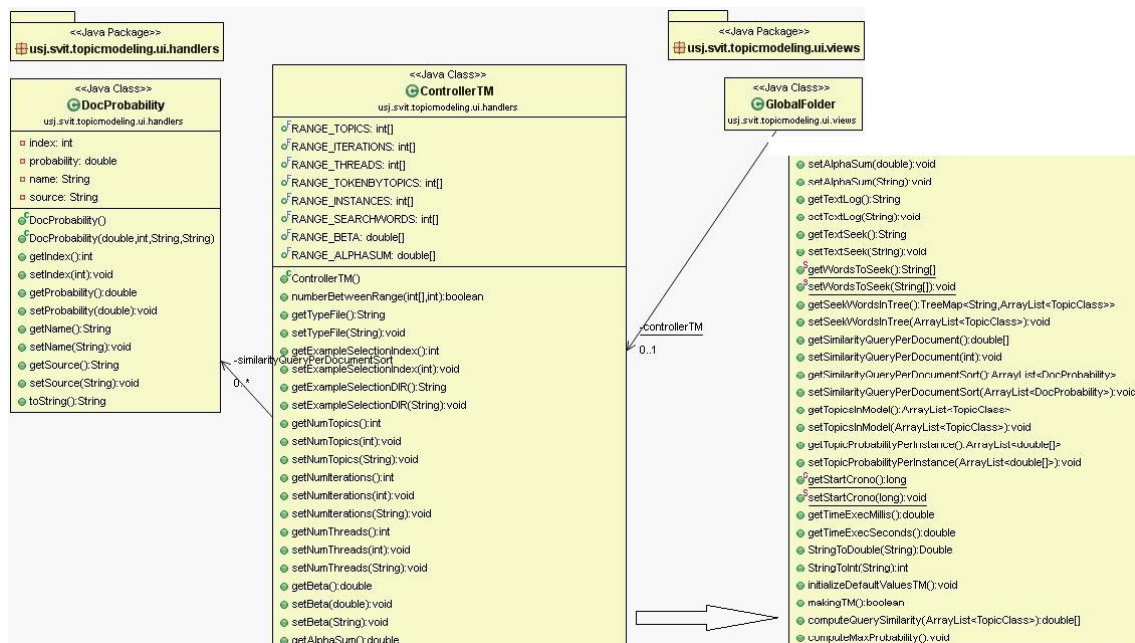
Figura 19: diagrama de clases UML para la parte de control del plug-in. Ampliación.
